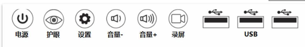
**电源：** 开机-一键开机蓝灯常亮；待机：一键待机红灯和蓝灯交替闪烁；关机：长按关机红灯常亮。
